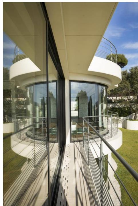
С площадью поверхности 550 м<sup>2</sup>, фасад состоит из металлического каркаса BWM 100, размещенного поверх необработанного бетонного фасада, покрытого и изолированного полиуретановой пеной, к которому монтируются 12-миллиметровые панели HI-MACS®. Термоформованные панели прекрасно следуют изгибам фасада, колоннам и окнам иллюминатора виллы, формируя в комплексе внешнюю облицовку.
